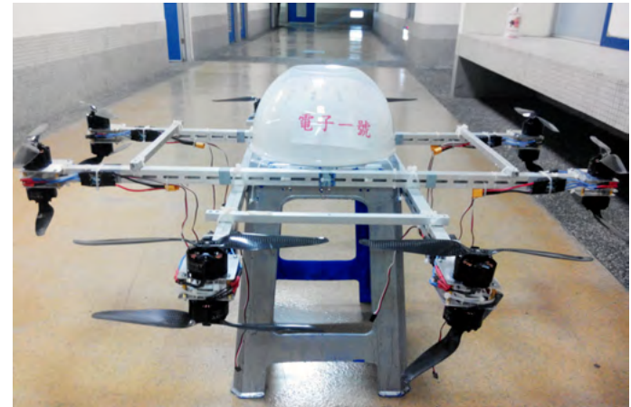
本系自行開發設計之 16 旋翼直升機
